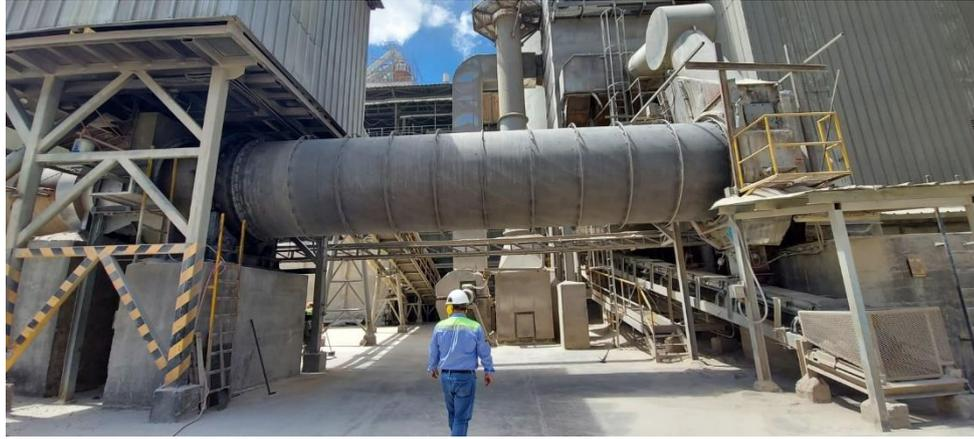
**Fig. 4.** Secador rotatorio con corriente paralela [3]
