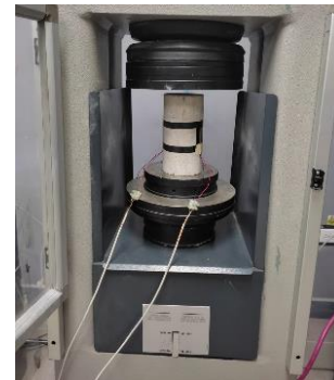
Figura 3. Cilindro preparado para ensayo. Conectado a equipo para lectura de esfuerzos y deformaciones mediante galgas extensiométricas.
