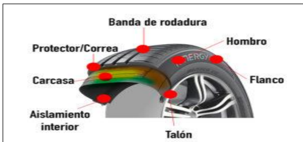
Figura 2. Estructura de una Llanta
