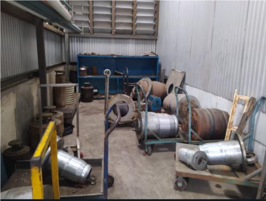
Figura 9. Bodega de Almacenamiento de formadores grandes diámetro
