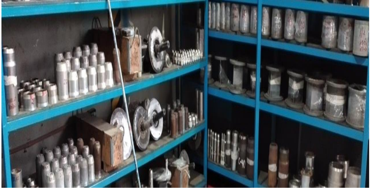
Figura 8. Almacenamiento de herramientas después del 5S.
