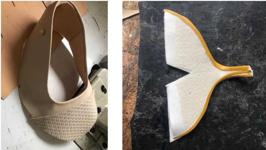
Ilustración 14 Doblado del calzado Fuente: Autora.
