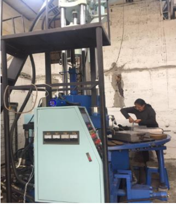
Ilustración 35 Maquina para la inyección de viruta de fibra Fuente: Autor
