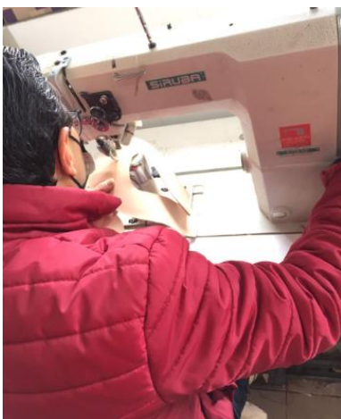
Ilustración 13 Cosido del calzado Fuente: Autora
