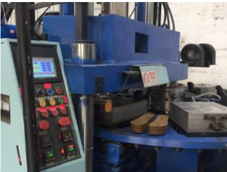
Ilustración 36 Enfriamiento de las plantas de viruta de fibra Fuente: Autor
