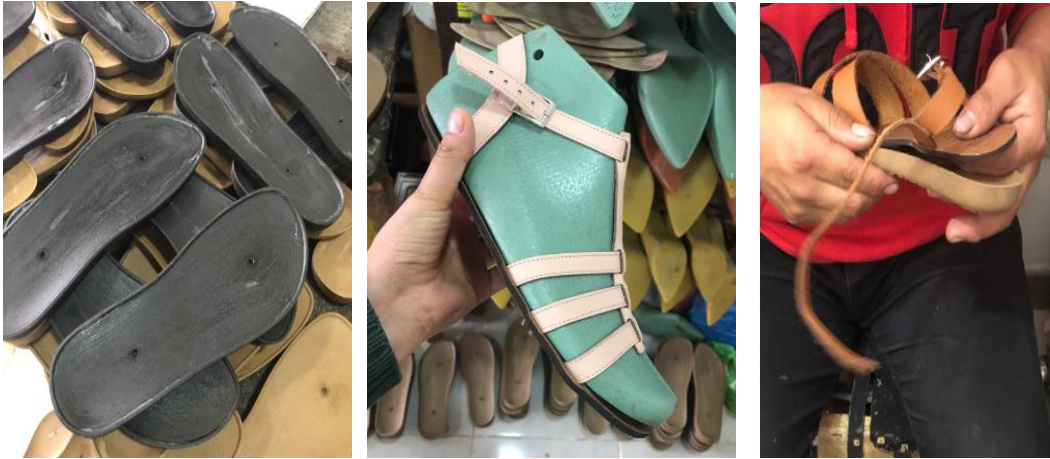
Ilustración 17 Plantado del calzado Fuente: Autora,
