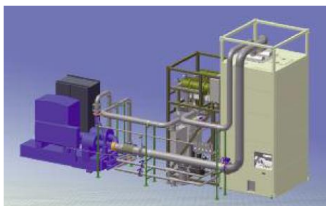
Figura 1. Modelo esquemático de equipos de licuefactor para 30 Toneladas por días de Nitrógeno.
