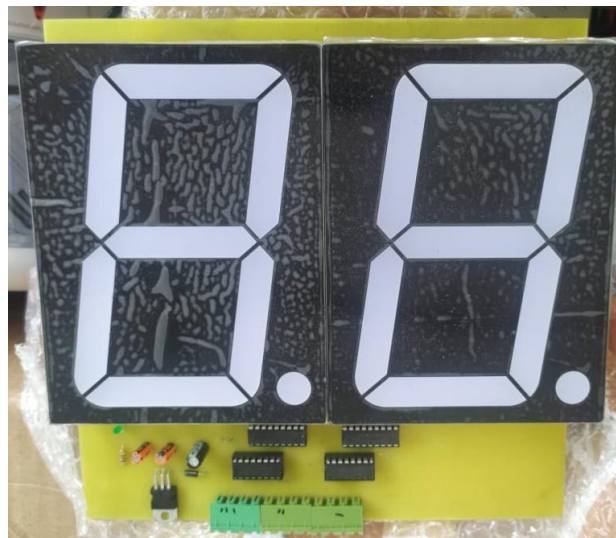
Figura 30 Tarjeta de LED de 7 segmentos de ánodo común
