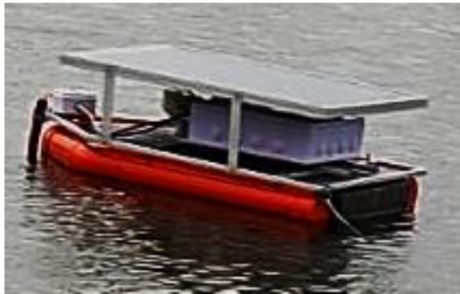
Figura 3.17 Estructura móvil terminada.
