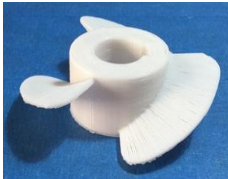
Figura 3.5 Impresión de propela en PLA
