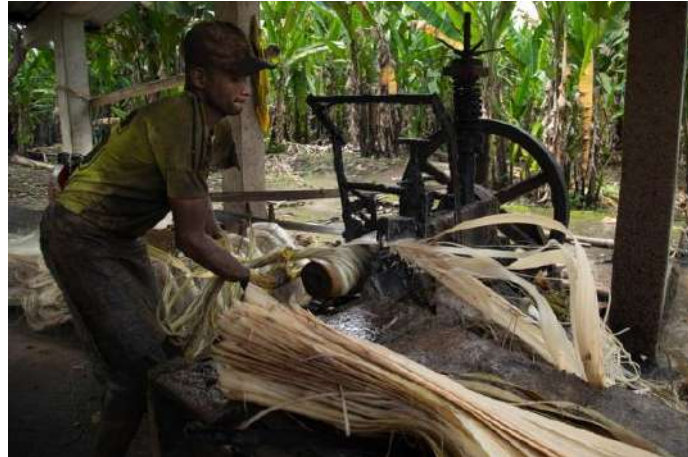
Fig. 3. 6 Proceso de "Desfibrado". Tomada de (Ecuador, 2019)
