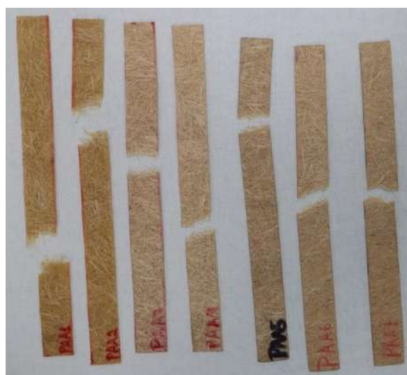
Fig. 4. 18 lote 2 después de ensayos de tracción
