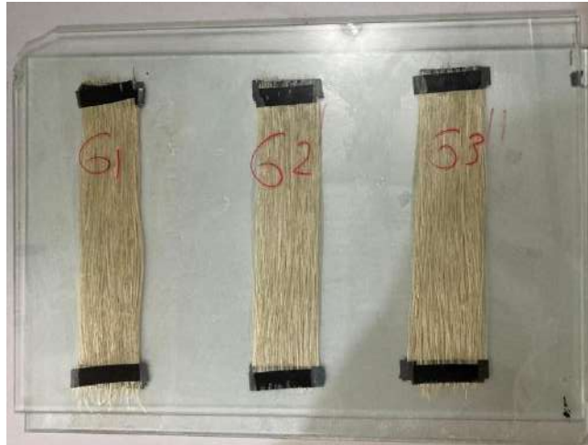
Fig. 3. 17 Grupos de fibra de abacá y resina epoxi pre-curado.
