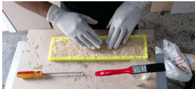
Fig. 3. 26 Aplicación del material compuesto al molde.
