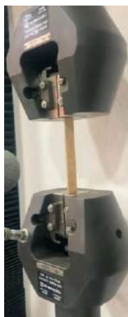
Fig. 3. 37 Ensayo de tracción probeta aleatoria
