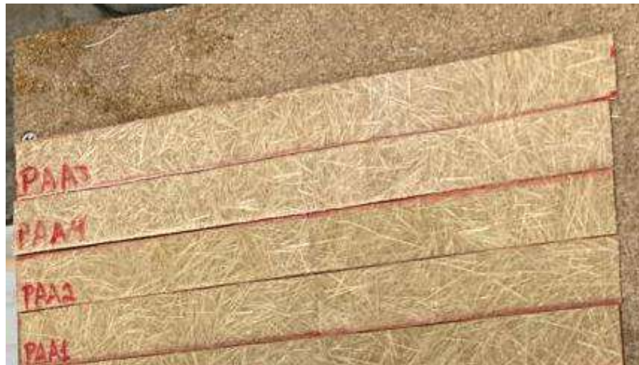
Fig. 3. 30 Probetas aleatorias terminadas.
