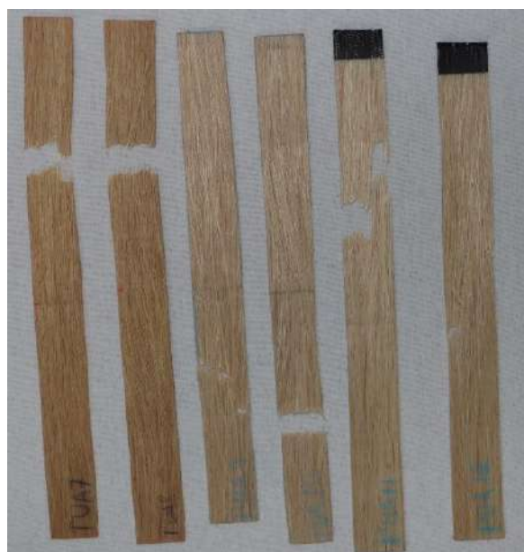
Fig. 4. 13 Lote 3 después de ensayos de tracción
