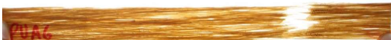
Fig. 4. 10 PUA6 después de ensayo de tracción
