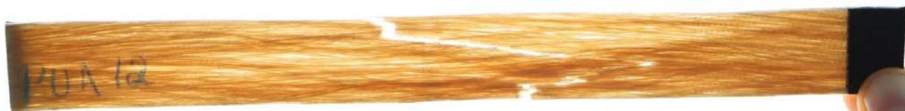
Fig. 4. 12 PUA12 después de ensayo de tracción.
