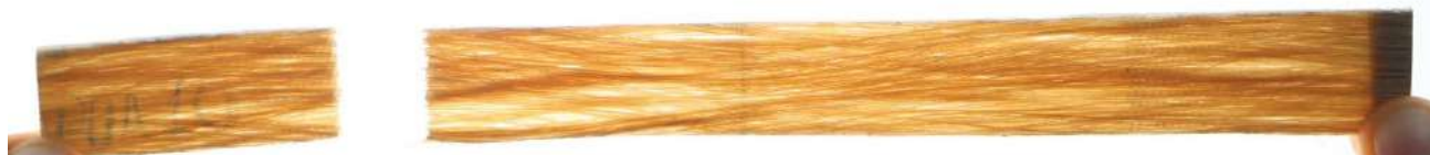
Fig. 4. 10 PUA10 después de ensayo de tracción.
