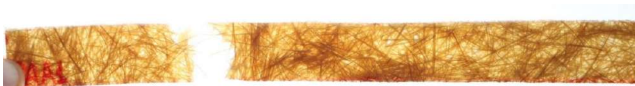
Fig. 4. 42 PAA1 después de ensayo de tracción.
