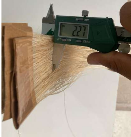
Fig. 3. 31 Espesor de las capas de fibra
