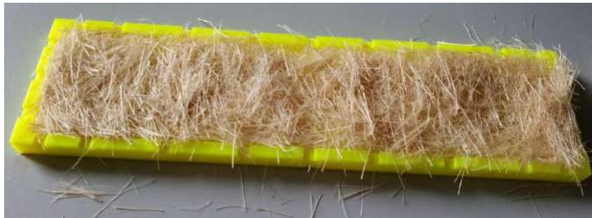
Fig. 3. 23 Fibras aleatorias dentro del molde
