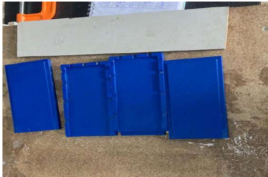
Fig. 3. 32 Secado del desmoldante en la superficie del molde
