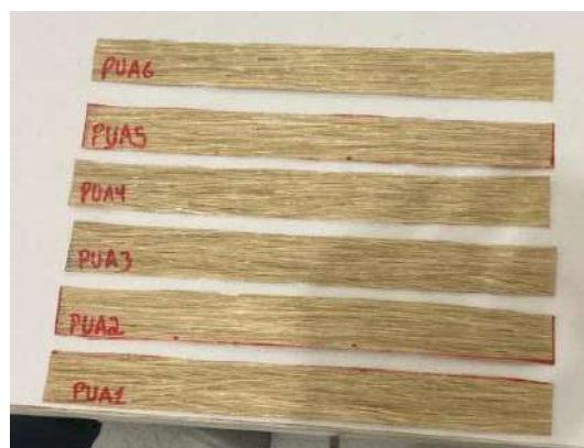
Fig. 3. 20 Probetas unidireccionales de fibra de abacá.
