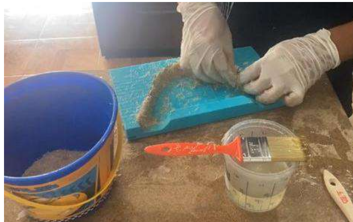
Fig. 3. 53 Aplicación de resina y fibra
