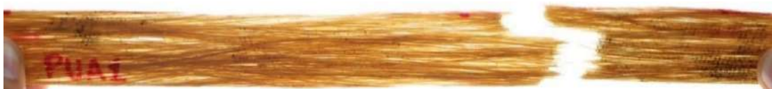
Fig. 4. 5 PUA1 después de ensayo de tracción.
