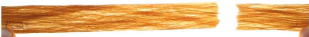
Fig. 4. 8 PUA8 después de ensayo de tracción.
