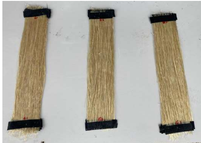
Fig. 3. 19 Grupos de fibra de abacá y resina epoxi post-curado.
