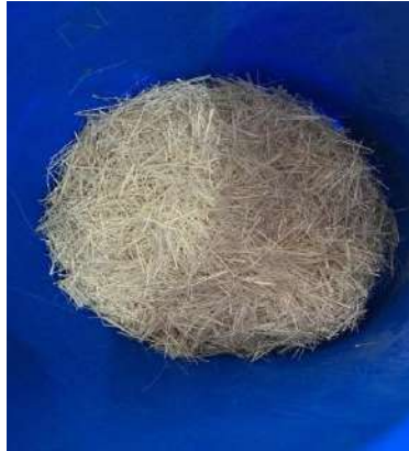
Fig. 3. 22 Fibras cortadas en longitudes aleatorias.
