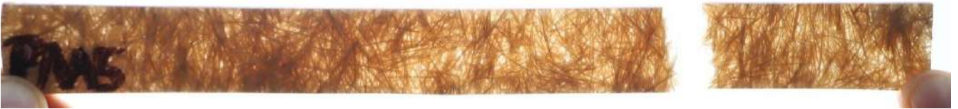
Fig. 4. 15 PAA5 después de ensayo de tracción.
