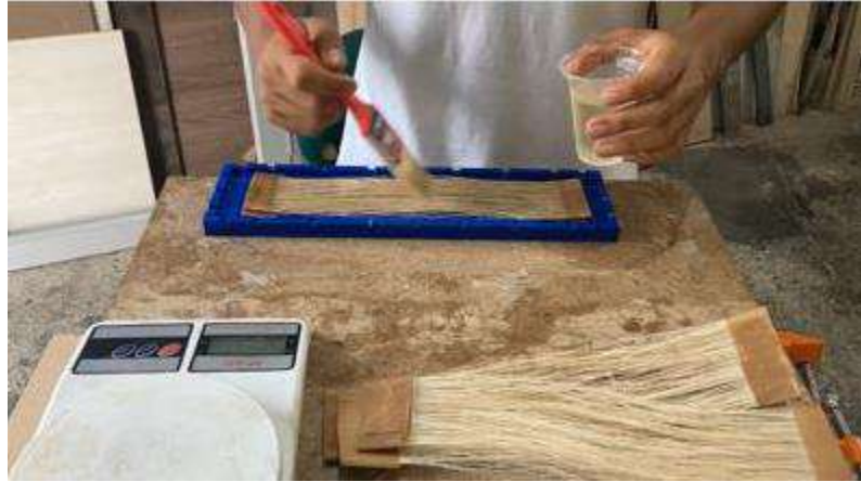
Fig. 3. 33 Aplicación de fibra y resina en molde
