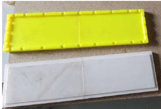
Fig. 3. 21 Molde (amarillo) y contraparte (Blanca) para probetas.
