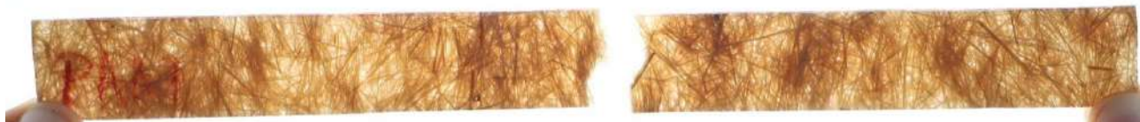
Fig. 4. 7 PAA7 después de ensayo de tracción.
