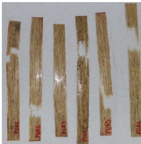
Fig. 4. 11 Lote 1 después de ensayos de tracción
