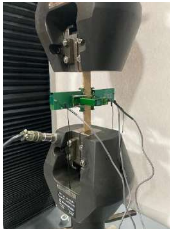
Fig. 3. 38 Ensayo de tracción con extensómetro de probeta aleatoria
