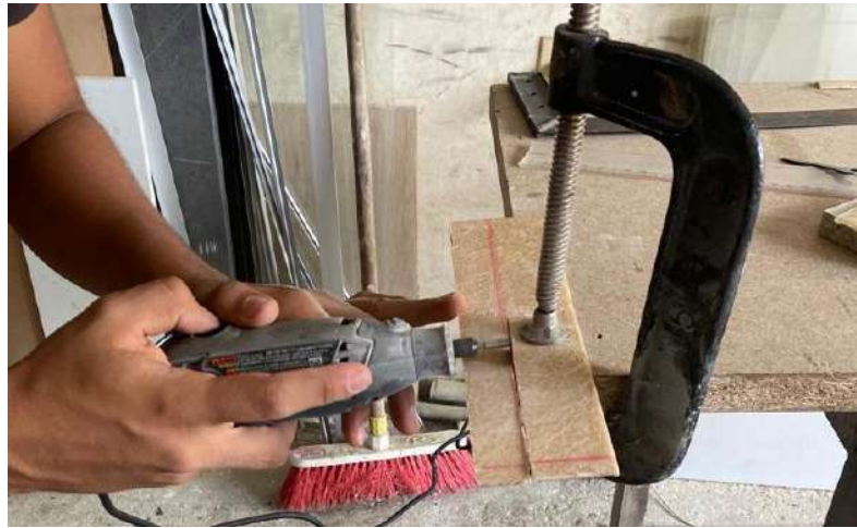
Fig. 3. 29 Corte de probetas.
