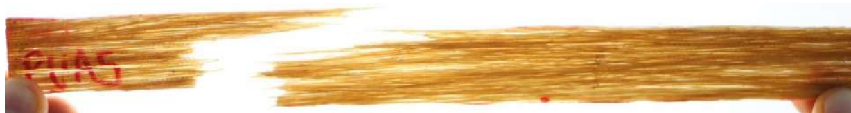
Fig. 4.9 PUA5 después de ensayo de tracción.
