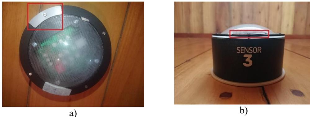
Figura 11 Sensor de contacto. (a) Vista superior; (b) Vista lateral.
