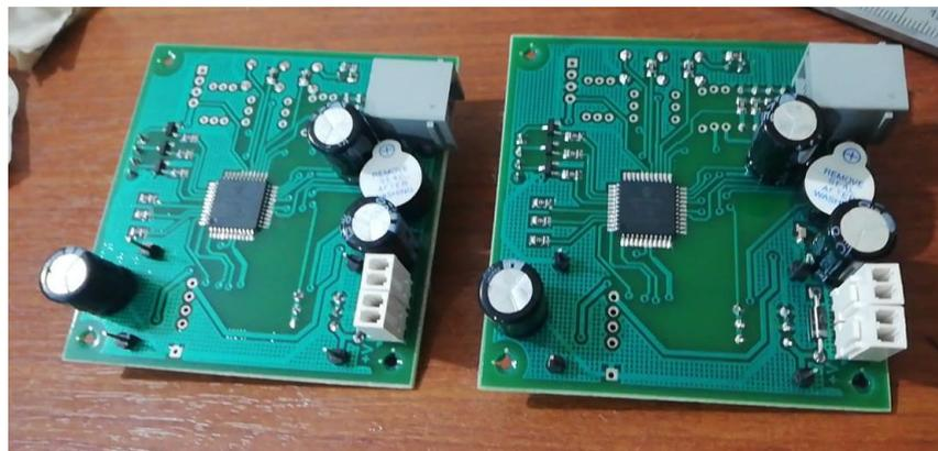
Figura A. 4 Ensamble del microcontrolador en la placa.
