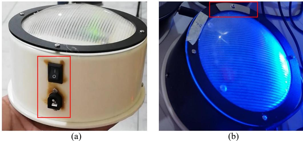
Figura 20 Dispositivo ensamblado. (a) Interruptor ON/OFF y pin de carga para las baterías; (b) sensor de contacto en el dispositivo.
