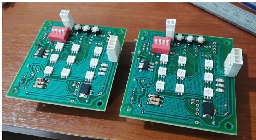
Figura A. 5 Ensamble de luces RGB en la placa.
