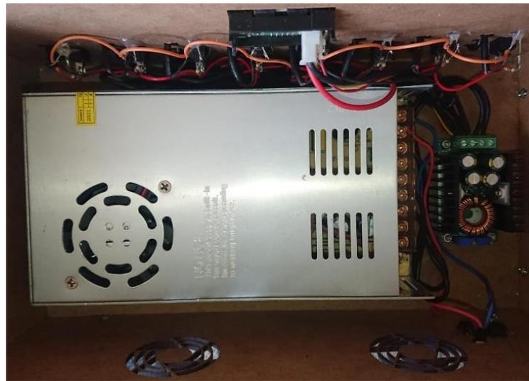
Figura 21 Vista interna de la fuente de alimentación.
