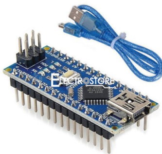
Figura 2.4: Arduino Nano. Fuente: Store [2019]
