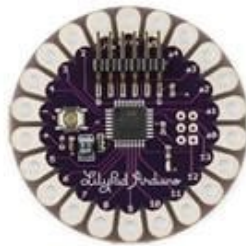
Figura 2.2: Arduino LilyPAD. Fuente: Lilypad [2019]
