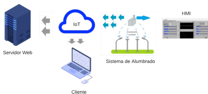
Figura 3.1: Diagrama de la red LoRa. Fuente: El autor
