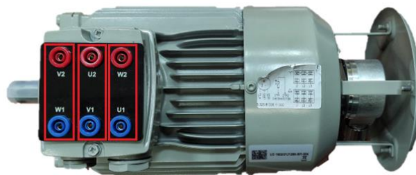
Figura 6: Conexión triángulo del motor trifásico.
