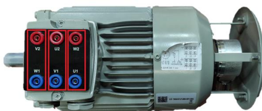
Figura 7. Conexión triángulo del motor.
