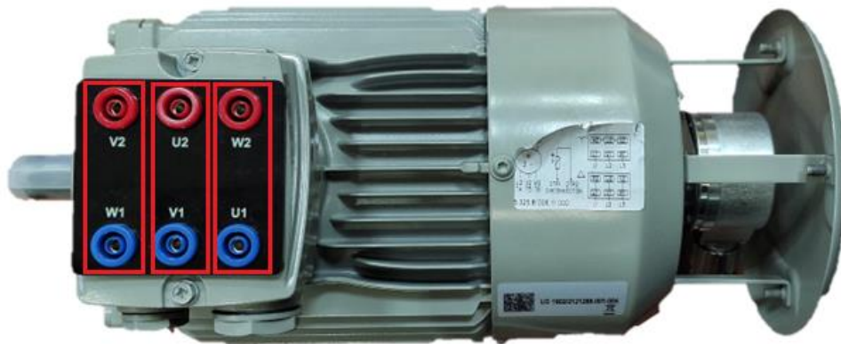
Figura 7. Conexión triángulo del motor.
