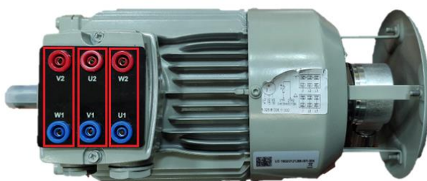
Figura 4: Conexión triángulo del motor trifásico.
