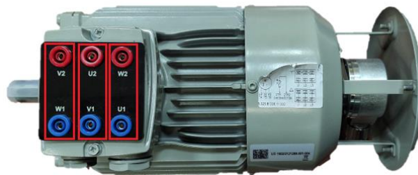
Figura 7. Conexión triángulo del motor.
