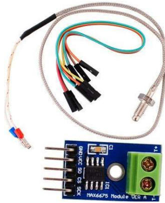
Figura 22. Termocupla tipo k y driver MAX 6675 [42]
