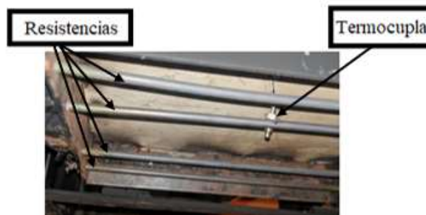
Figura 45. Resistencias y termocupla
