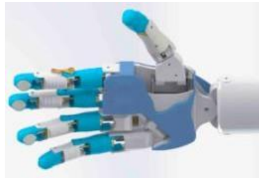
Figura 1. Prótesis mecánica con tendones en las juntas [17]
