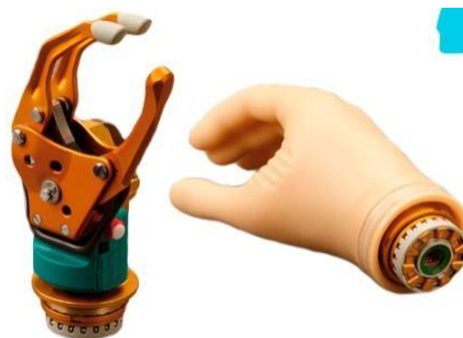
Figura 2. Prótesis electrónica con sistema de sujeción de pinza [17]
