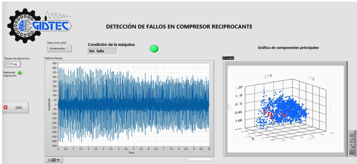
Figura 17: Sistema de detección de fallos en línea para compresor recíprocante en condición normal. Fuente: Autor.
