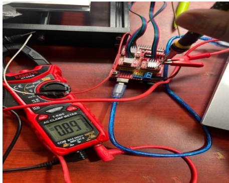
Figura 50 - Calibración en X, Y, Z en su tensión de referencia calculada.
