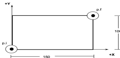
Figura 6 - Movimiento de punto a punto[11].
