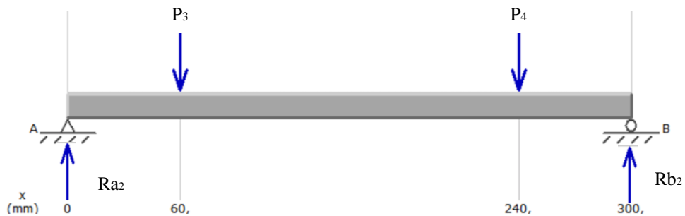
Figura 37 - Esquema de fuerzas en la guía[45].
