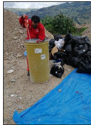
Ilustración 20. Medida de la altura libre superior y medición de las dimensiones del cilindro.
