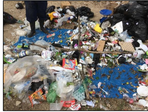
Ilustración 19. Homogenización y cuarteo de los residuos. Fuente: Elaboración propia.
