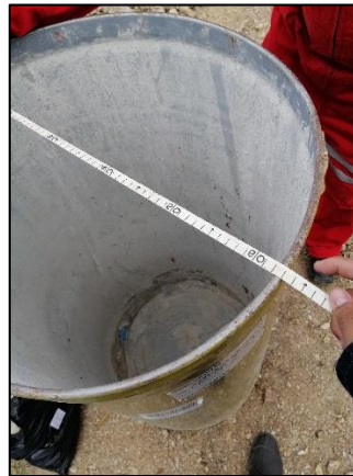
Ilustración 20. Medida de la altura libre superior y medición de las dimensiones del cilindro.
