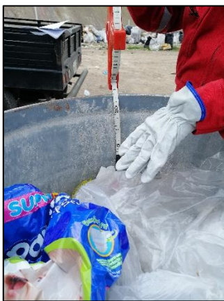
Ilustración 20. Medida de la altura libre superior y medición de las dimensiones del cilindro.
