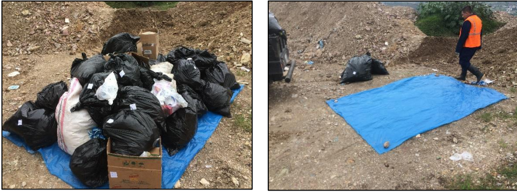
Ilustración 18. Preparación de las muestras para el proceso de cuarteo. Fuente: Elaboración propia.
