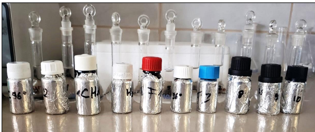
Figura 27. Preparación de las diluciones del ácido gálico.
