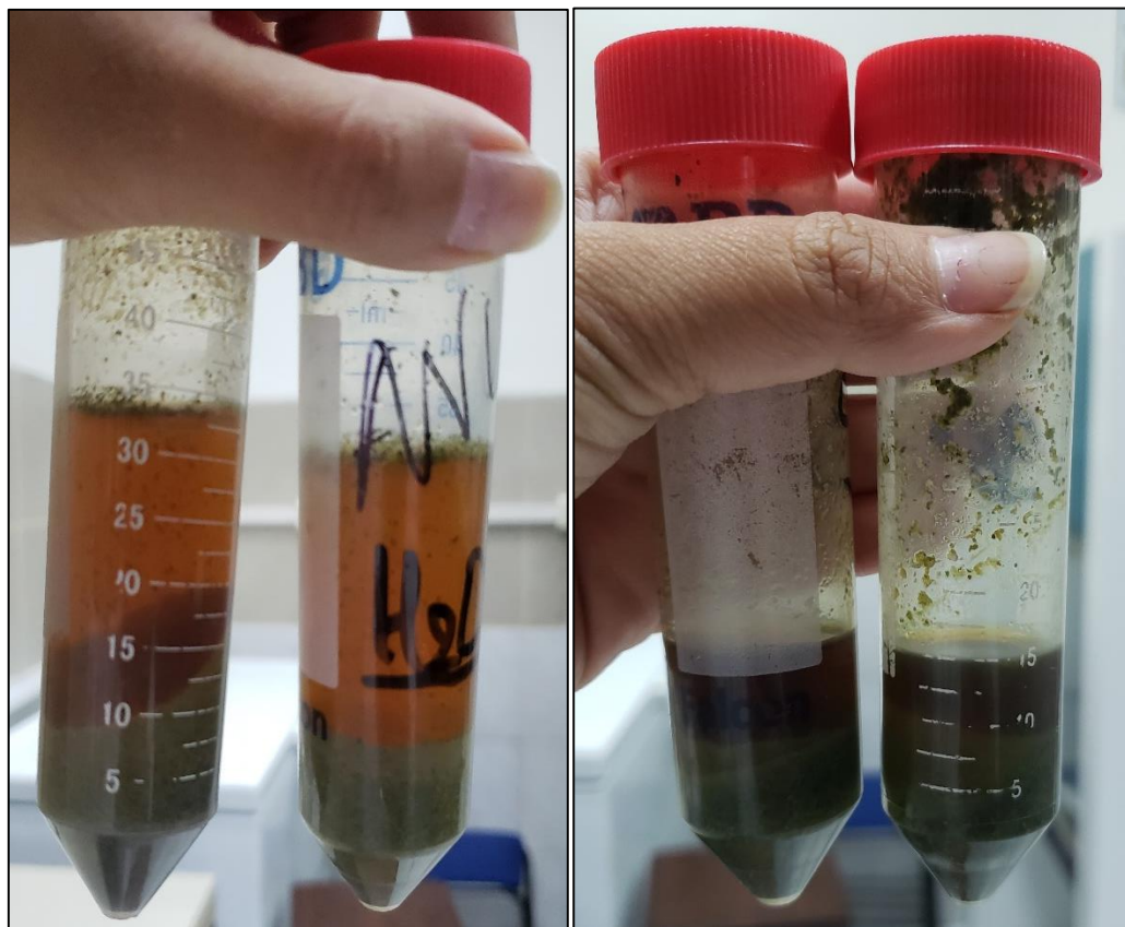
Figura 26. Filtrar el sobrenadante de los extractos y colocarlos en un frasco ámbar.
