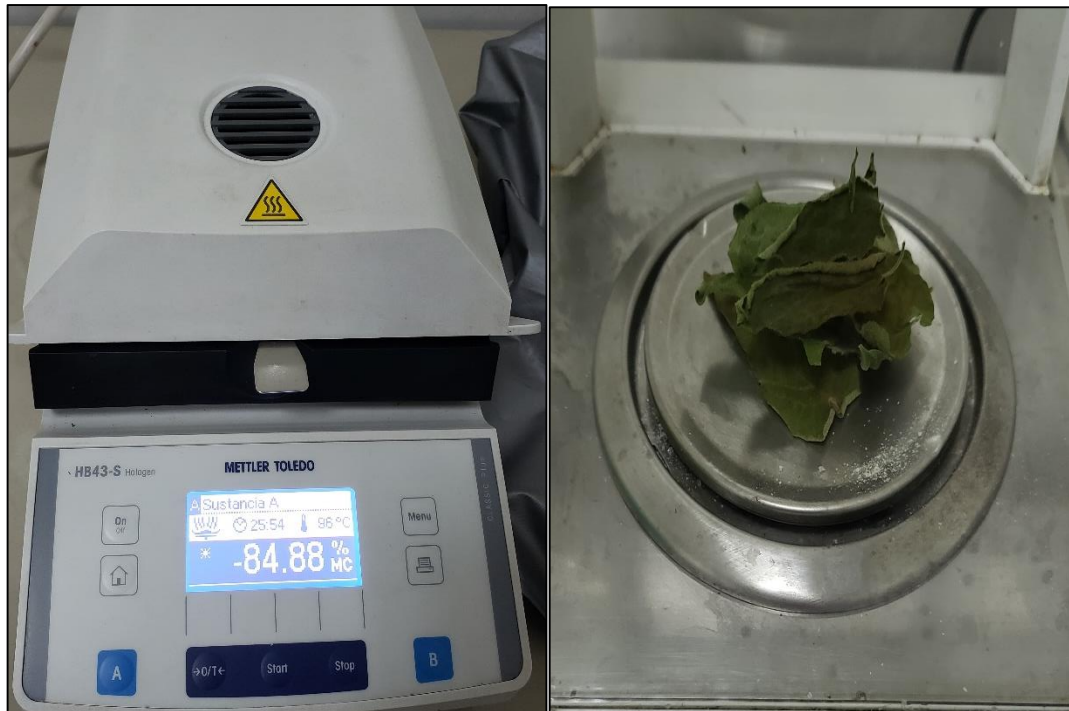
Figura 34. Dejar las hojas en el halógeno por 30 min.
