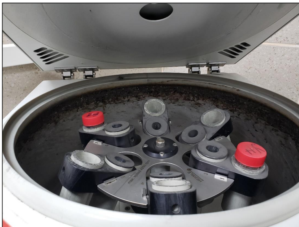
Figura 25. Llevar los tubos Falcon a la centrífuga a 7500 rpm por 30 minutos.
