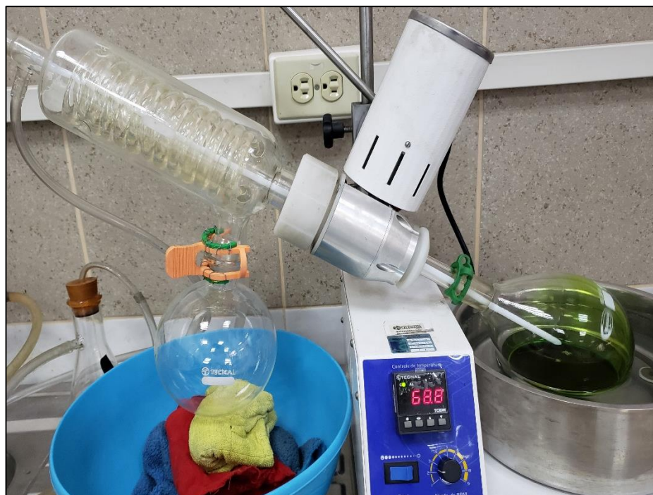
Figura 23. Extracción de alcohol en el rotavapor.
