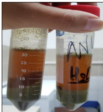
Figura 7: Extractos acuoso, después de la centrifuga
