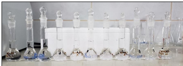
Figura 8: Diluciones para la curva de calibración
