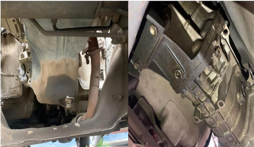
*Figura 9. Fuga de Aceite por los Tapones de Motor y Caja de Cambios.*
