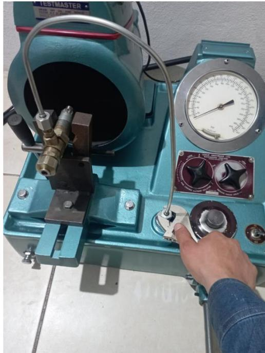
Demostración de la pulverización de un inyector de orificios
