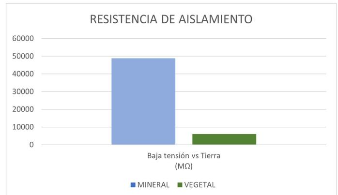
Fig. 5. RESISTENCIA DE AISLAMIENTO BT vs GRND. FUENTE: AUTOR
