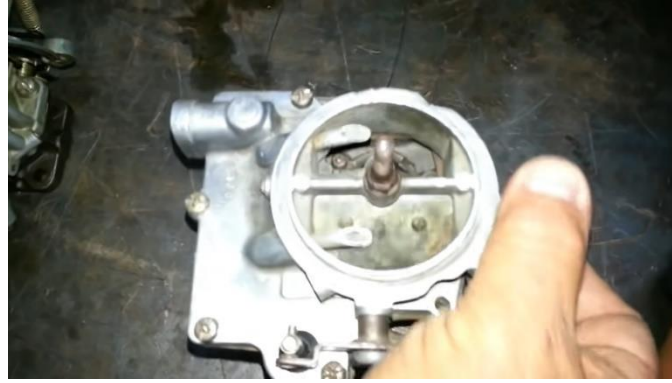
Figura 5 Comprobación de eje mariposa de acelerador
