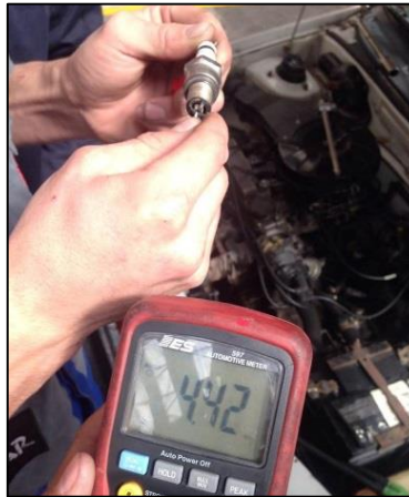
Figura 8 Comprobación de la resistencia de las bujías
