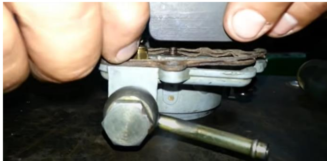
Figura 4 Comprobación de la aguja de entrada del carburador.
