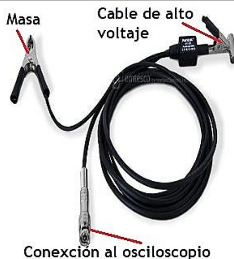
Figura 6. Cable para medición de alto voltaje.
