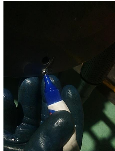
Figura 8. Colocación de una segunda marca en el volante motor.
