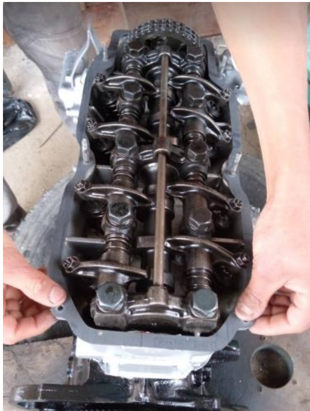
ANEXO 13: Cambio de junta de tapa válvulas
