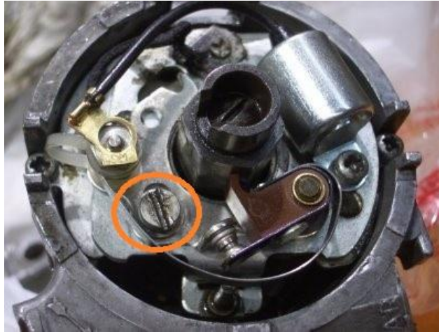
Figura 3 Tornillo de ajuste del ruptor
