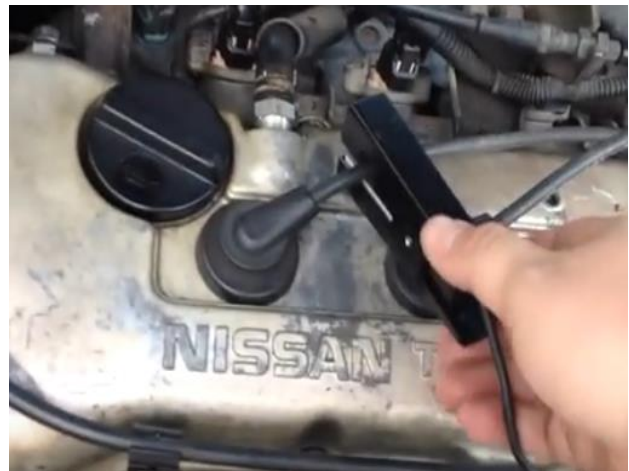
Figura 2 Conexión de la pinza inductiva de la pistola estroboscópica en el cable de alto voltaje del primer cilindro.
