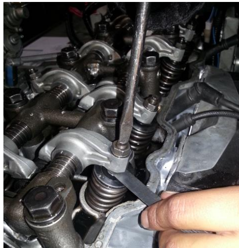
Figura 3. Calibración de válvulas.
