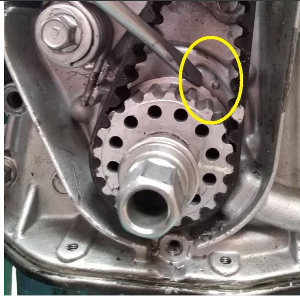
Figura 5. Marca del bloque motor coincide con la marca en el piñón del cigüeñal.
