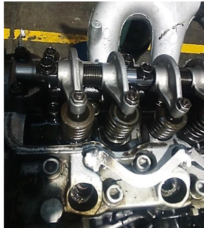
Figura 6. Válvulas de admisión y escape no accionadas.
