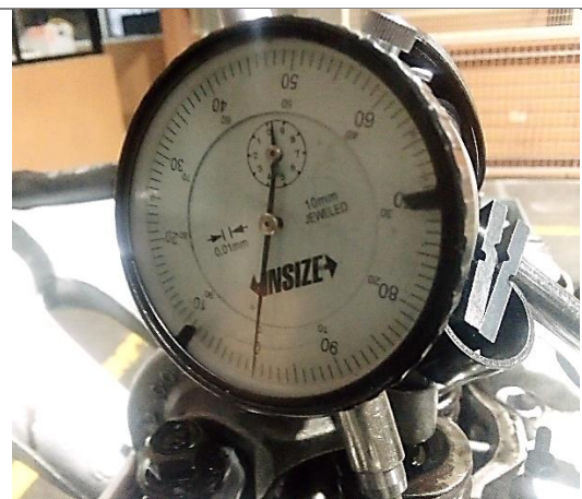
Figura 10. Colocación del instrumento en cero.
