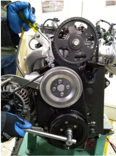
Figura 4. Giro del cigüeñal en sentido normal de funcionamiento del motor.
