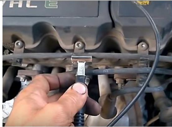
Figura 8. Colocación del sensor al cable de alto voltaje.
