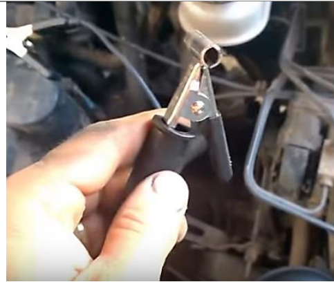
Figura 7. Sensor captador de corriente.
