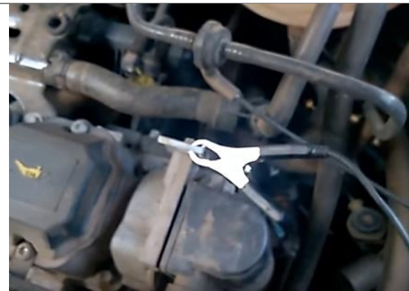
Figura 9. Conexión del lagarto a masa.
