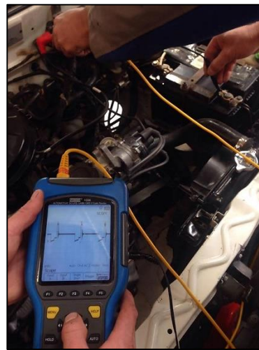
Figura 5. Obtención del oscilograma del circuito primario de encendido.
