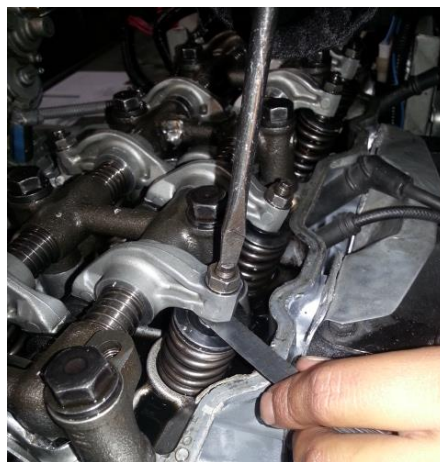
Figura 9 Calibración de válvulas
