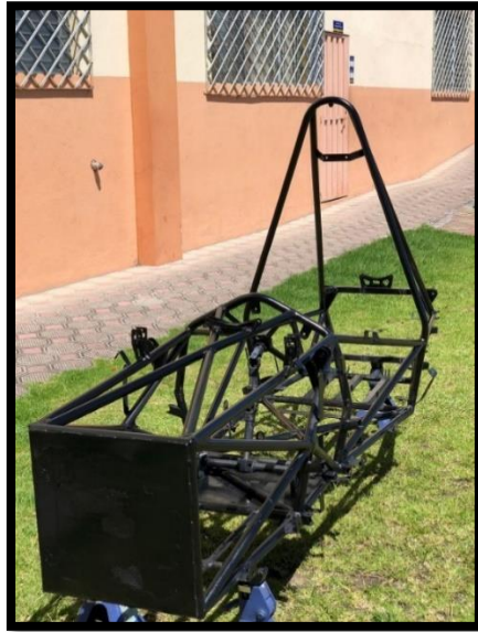
Figura 3.10 Pintado del nuevo chasis
