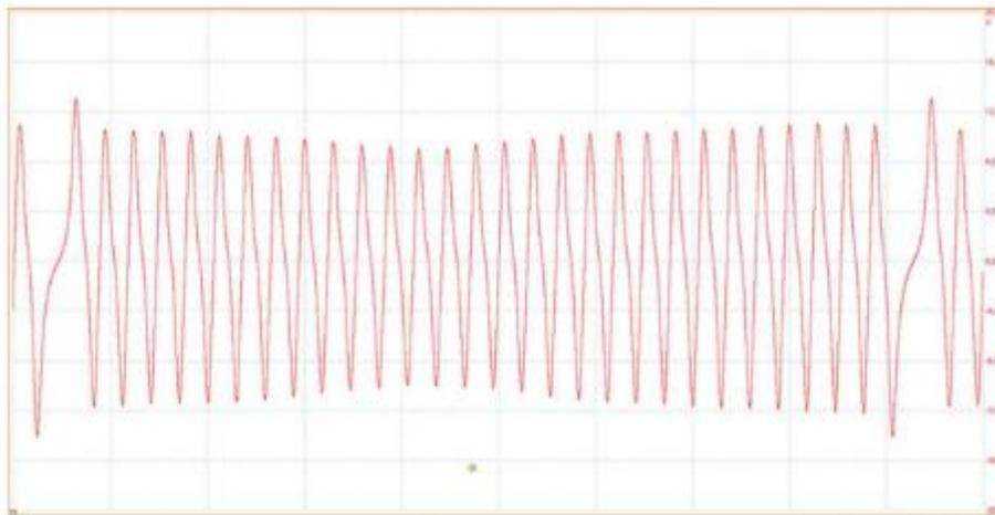
Figura 26. Curva característica del sensor CKP Inductivo. Fuente: (Exxostest, 2015).
