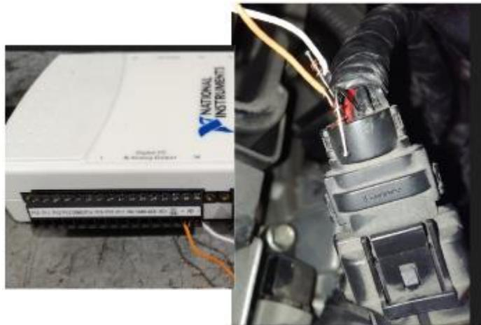
Figura 48. Conexión del sensor CKP a la tarjeta. Fuente: El Autor.
