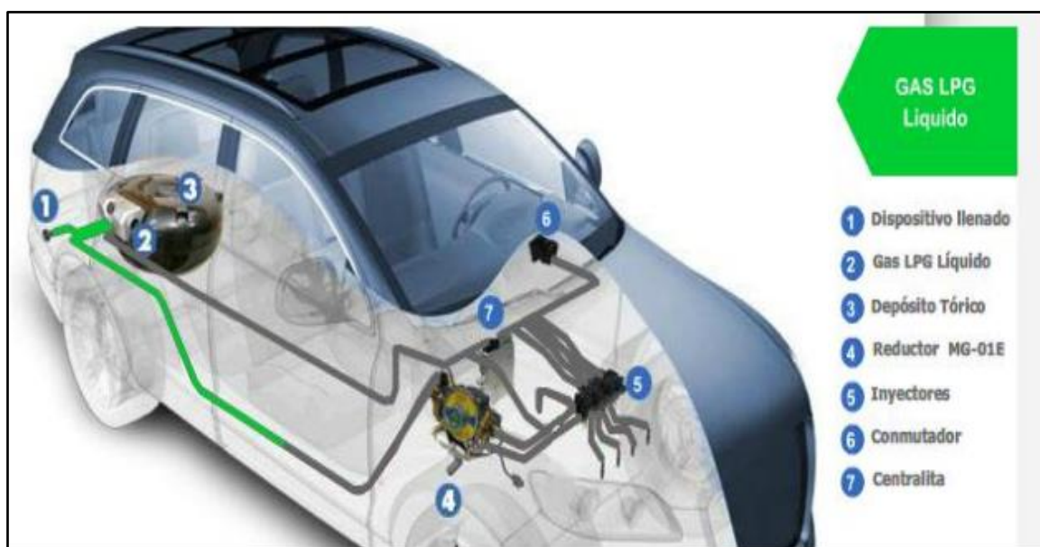
Figura 6. Recorrido del GLP líquido hasta el evaporador o regulador de presión. Fuente: (Carranza, 2012).
