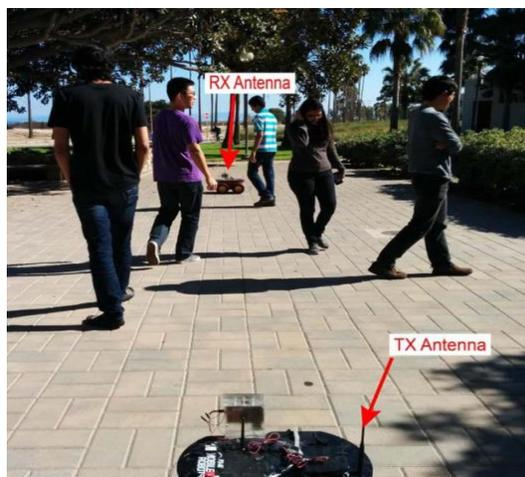
*Ilustración 8. Un transmisor y un receptor fijos son responsables de determinar el número de personas mediante mediciones de potencia. [30]*
