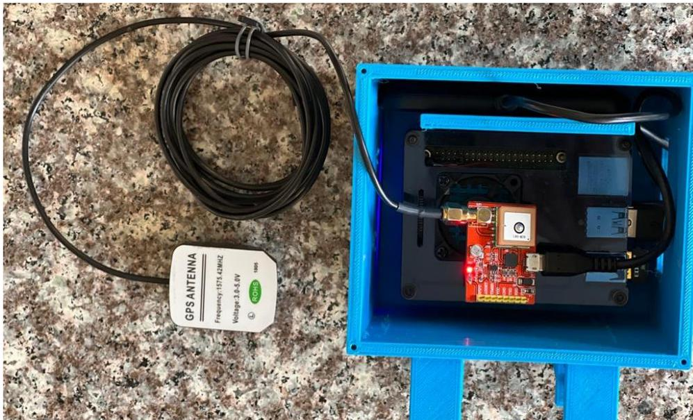
Ilustración 17. Raspberry junto a los diferentes periféricos dentro de la caja. (Fuente: Autor)
