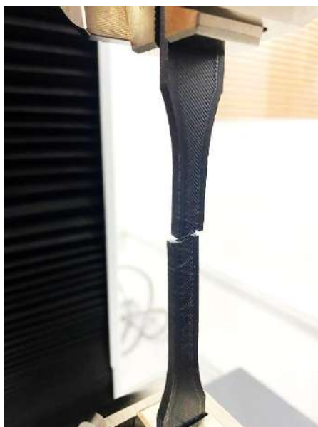
Figura 3. 25 Ensayo de probeta de fibra de carbono.
