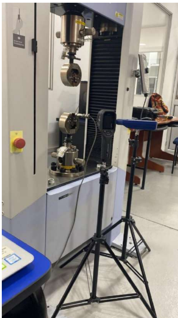
Figura 3. 22 Maquina de ensayos universales SHIMAZU 300kN con implementos adicionales de análisis.
