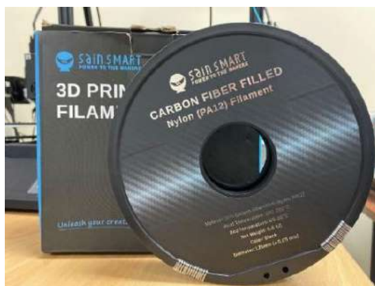
Figura 3. 6 Filamento PA12, estimado de 15% de carbono y 85% de Nylon.
