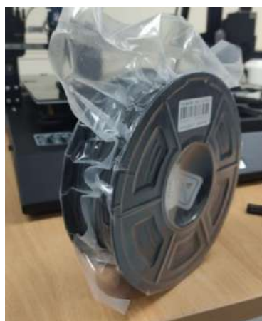
Figura 3. 5 Filamento de fibra de carbono, estimado de 20% de carbono y 80% de PLA.
