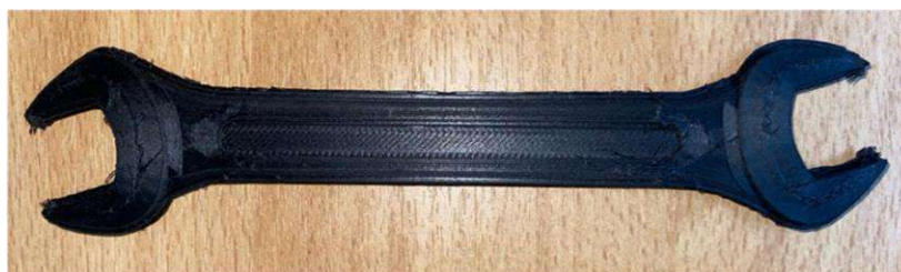
Figura 4. 41 Llave media impresa en PA12.
