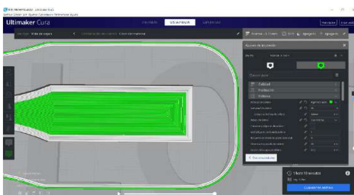
Figura 3. 9 Probeta en el software UltimakerCura- Patrón Concéntrico con 90% de relleno.
