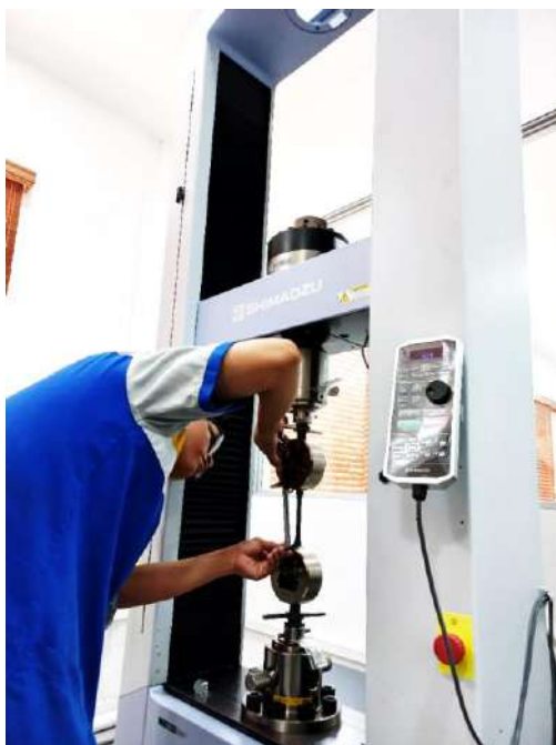
Figura CI. 3 Medición de la longitud calibrada de una probeta en los ensayos de tracción.
