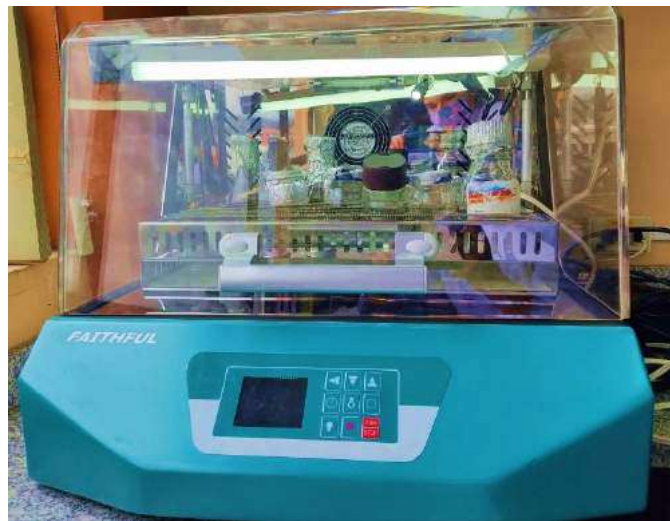
Fotografía 19: Cámara de Incubación con muestras para ensayos de reactivación
