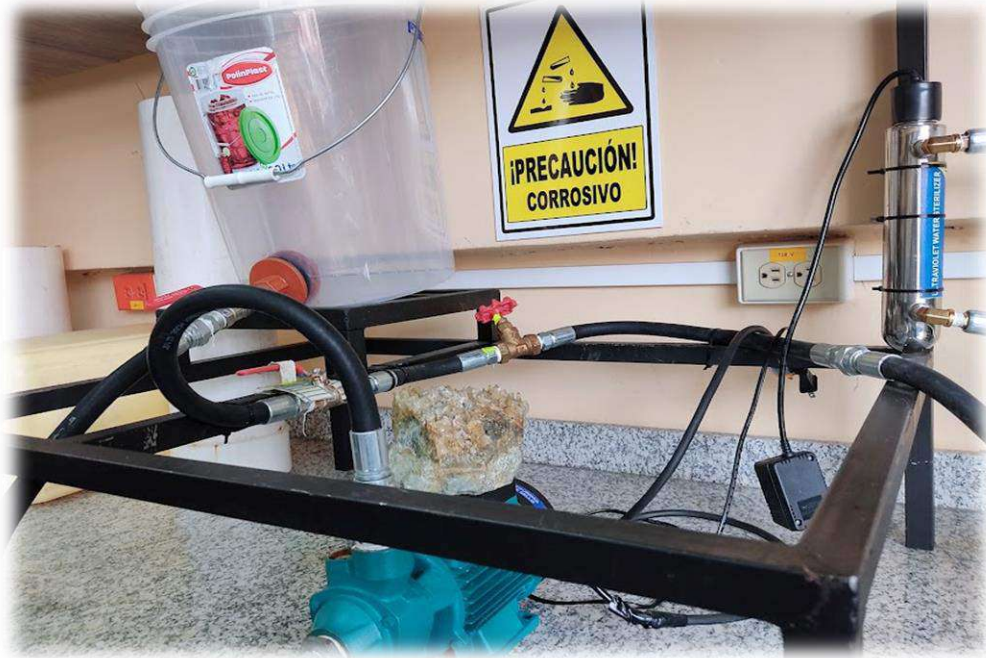
Fotografía 1: Reactor experimental tubular UV de lámpara de baja presión
