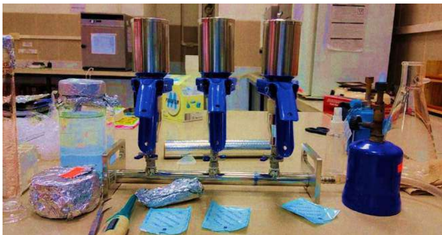
Fotografía 15: Sistema listo para realizar filtración, siguiendo normas de desinfección
