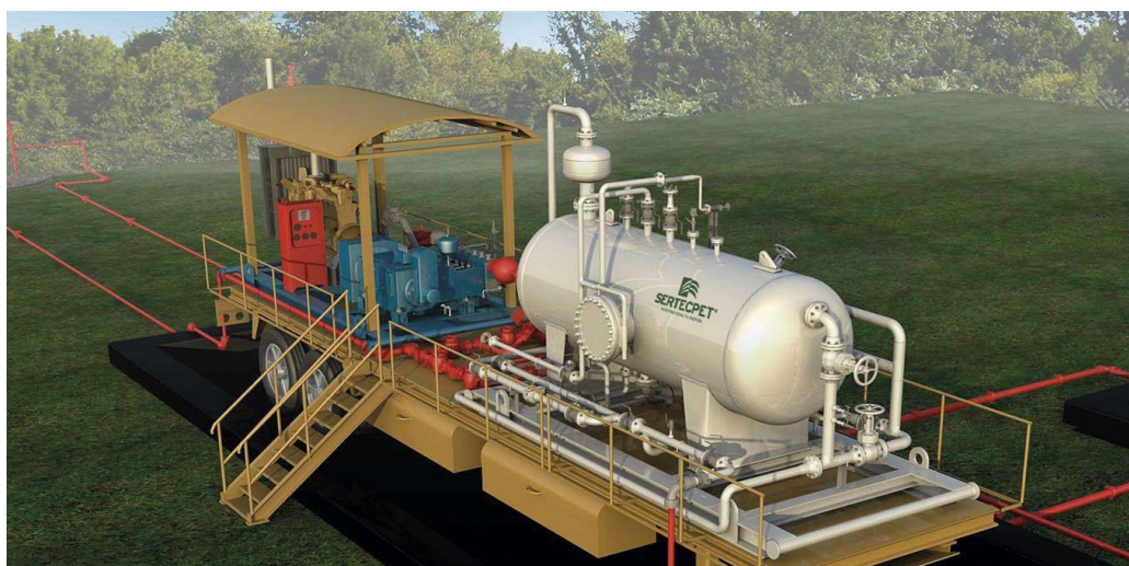
Figura 2. Unidad de evaluación móvil (MTU) de la empresa SERTECPET.
