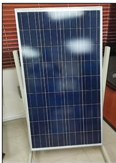
Ilustración 27. Estructura de la base del panel solar
