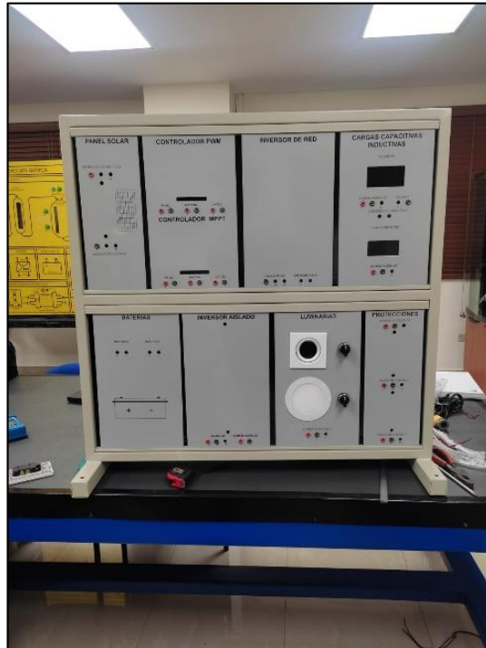
Ilustración 63. Armado del módulo con colocación de láminas
