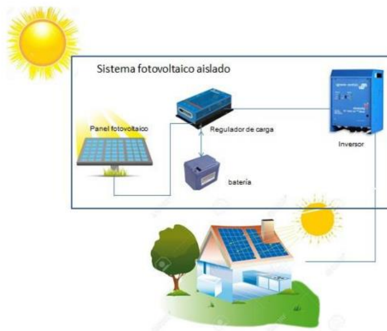
Ilustración 5: Sistema Fotovoltaico aislado a la red
