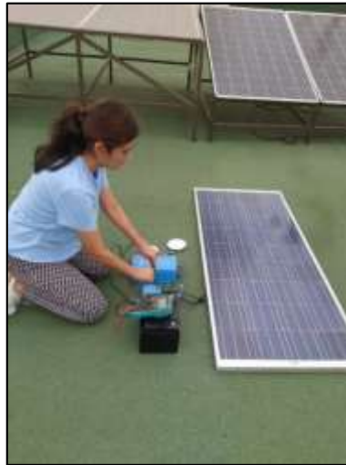
Ilustración No. 50: Medición de los parámetros con multímetro
