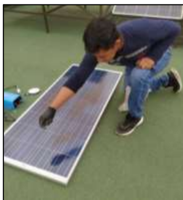
Ilustración No. 52: Simulación de suciedad en la superficie del panel
