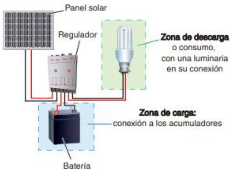
FIGURA. 19 CONEXIÓN DEL REGULADOR (ELEC_01)
