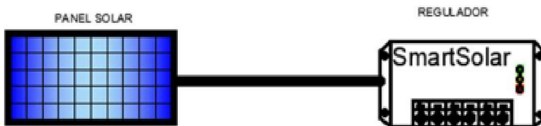
FIGURA. 33 PANEL SOLAR-REGULADOR (AUTOR)
