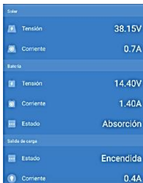
FIGURA. 39 DATOS EN TIEMPO REAL APLICACIÓN MÓVIL (VISTRON ENERGY) (AUTOR)
