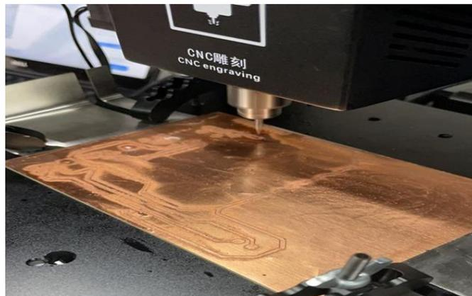
*Fig. 42.- Impresora CNC en proceso de creación de PCB
