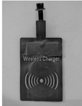
**Figura 10.** Receptor de carga inalámbrico.
