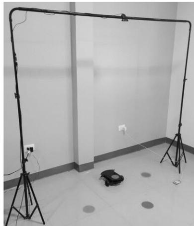
**Figura 130.** Estructura armada de la cámara USB.
