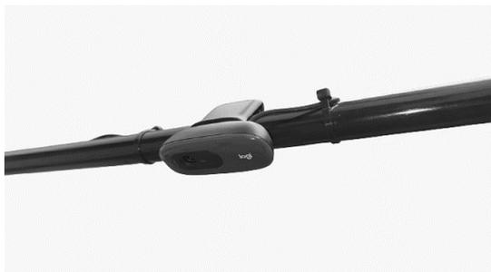
**Figura 131.** Cámara USB centrada en la tubería PVC.
