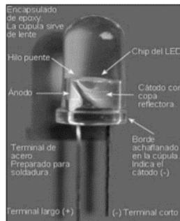
**Figura 19.** Estructura de un LED (Déleg, 2010).
