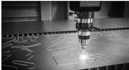
**Figura 22.** Corte realizado por láser en acrílico (Salvador, 2019)
