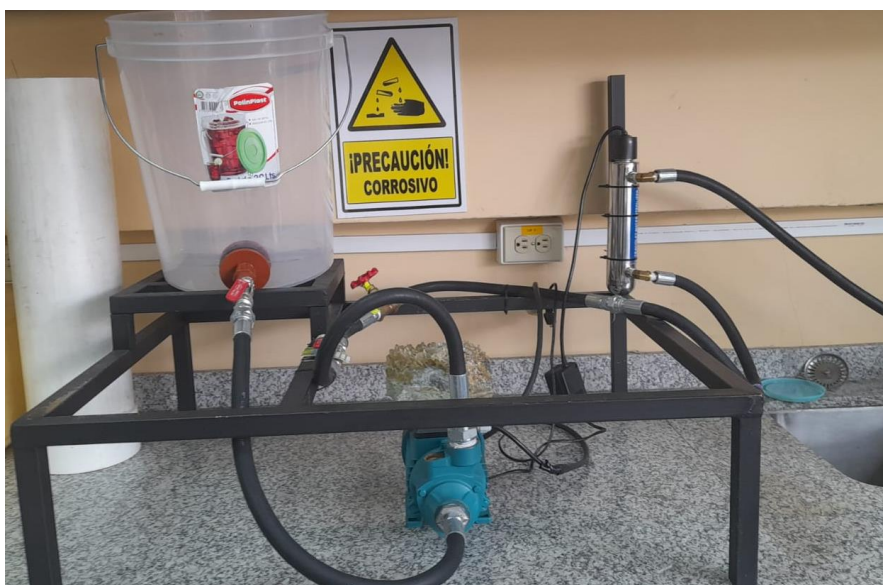
Ilustración 5. Esquema de desinfección ultravioleta utilizada en el laboratorio
