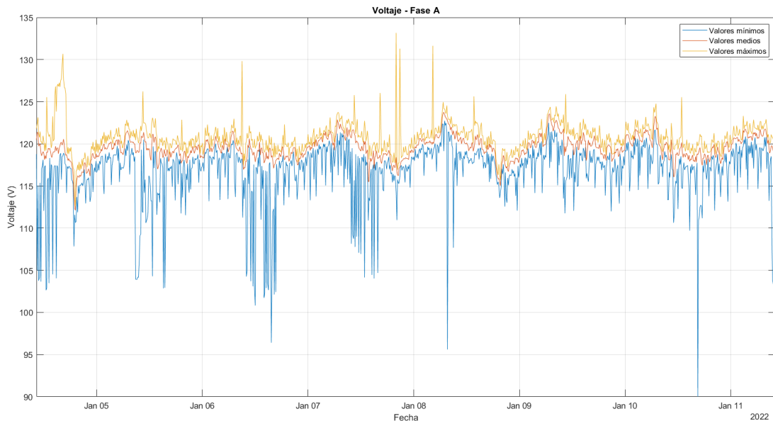
Figura D.1: Niveles de tensión - Fase A
