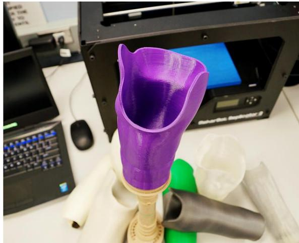
**Nota:** *Socket impreso en 3D luego de haber sido modelado en un software de diseño, tomado de Ottobock (2014).*
