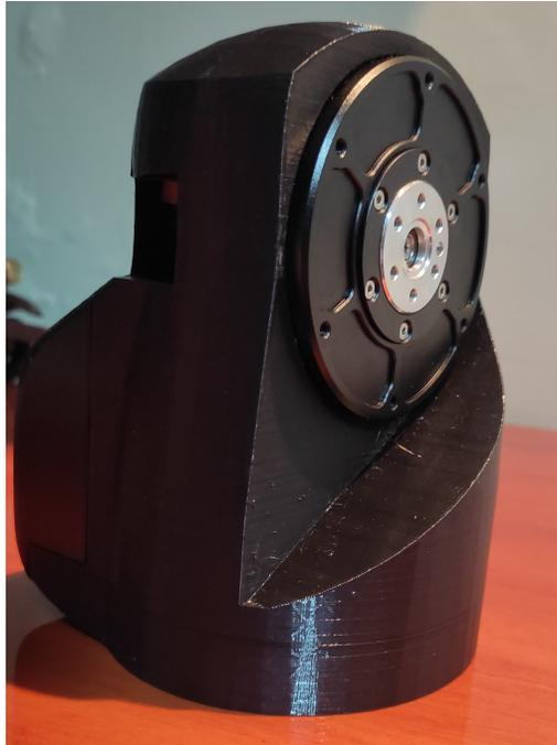
**Nota:** Se muestra la impresión en PLA del húmero junto con el motor RMD-x6, elaboración propia.
