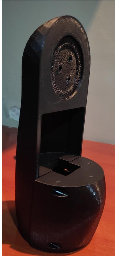
**Nota:** *Impresión en PLA de la carcasa que recubrirá el sistema interno, elaboración propia.*
