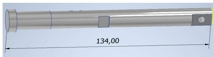
**Nota:** *Este eje va acoplado a la parte de la muñeca y la parte inferior va hacia un rodamiento para que el eje pueda rotar, tomado de Romero y Pucha (2020).*
