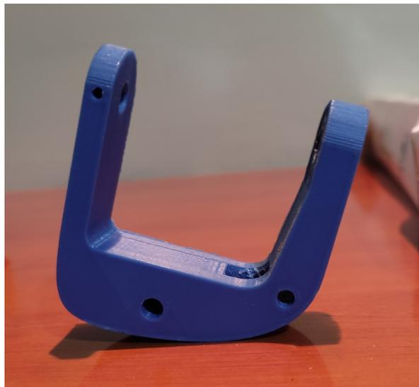
**Nota:** Acople de la muñeca impreso en ABS y que acopla al sistema interno y al sistema de la mano, elaboración propia.
