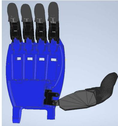
**Nota:** *En la parte delantera se observa donde irán insertados los motores lienales, y en la parte inferior se ve el agujero para colocar ya sea una placa electrónica o el servomotor para que la mano realice el movimiento de flexión y extensión, elaboración propia.*
