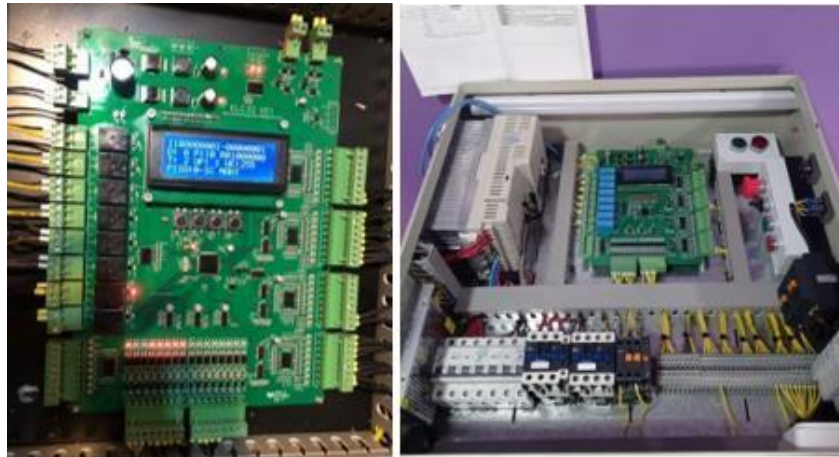
Figura 17. Encendido de placa central y caja de control terminada. Los autores
