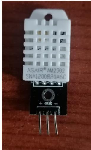
*Nota: Sensor de humedad y temperatura DHT22.*
