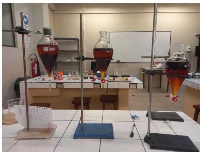
Figura 13 Separación de las fases en un balón de decantación
