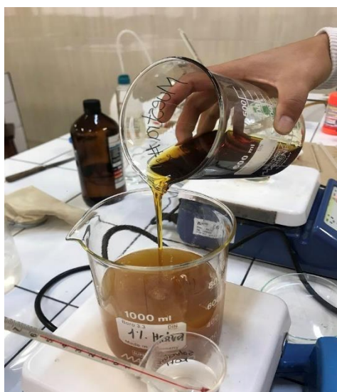
Figura 12 Mezcla del Aceite con el Metóxido
