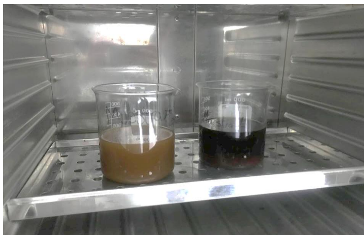
Figura 10 Colocación de muestras del aceite filtrado y lavado en la estufa
