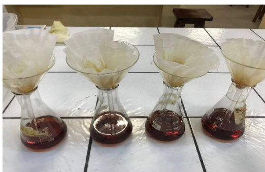
Figura 8 Filtrado de la muestra de aceite vegetal usado
