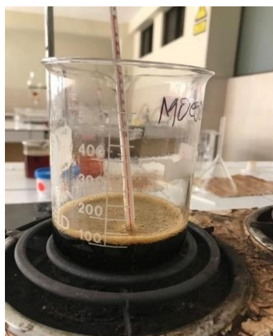
Figura 14 Eliminación del agua de las muestras de biodiesel
