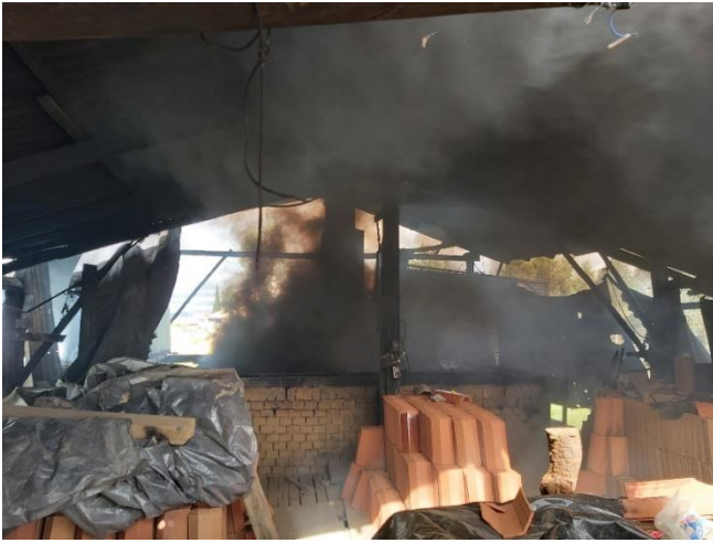
Imagen 1: Emisiones de Material Particulado y Gases de Combustión.
