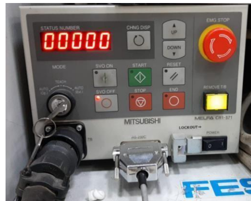
Figura 63: Conexión Controlador robot.
