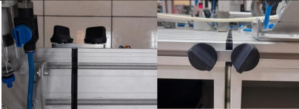
Figura 16: Estaciones aseguradas con abrazadera de perfil FESTO.
