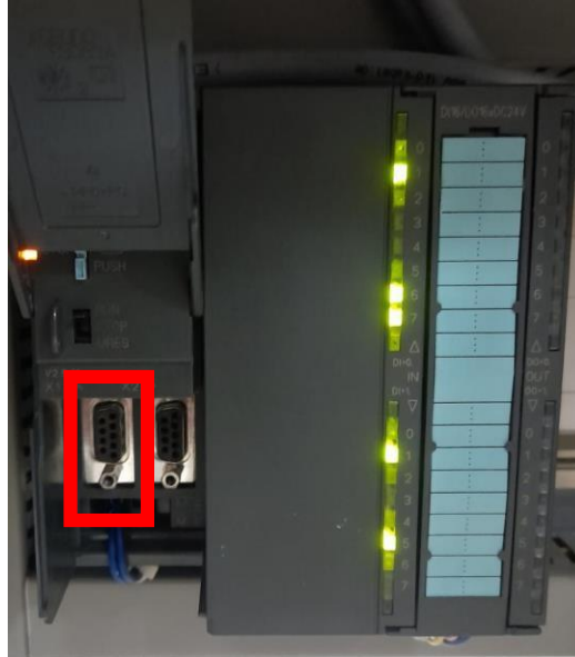
Figura 24: Espacio de conexión para la interfaz MPI.
