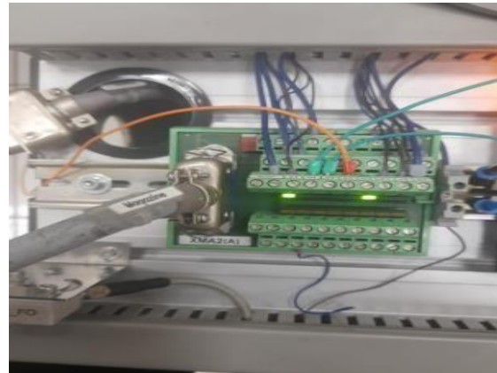
Figura 64: Bornera de conexión de señales. Figura 65: Conexión de cables estación robot y bornera de conexión
