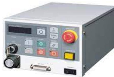
**Nota:** Se muestra el hardware del controlador CR1-571. (*RV-2AJ Standard Specifications Manual*, 2009).
