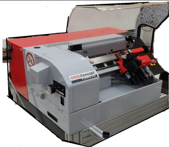
**37)** Para la siguiente prueba se debe activar el bit 14, el cuál controla el mandril donde sujetará una pieza; para que este bit se active la condición es que la puerta esté abierta, además de las mostradas en la tabla.
