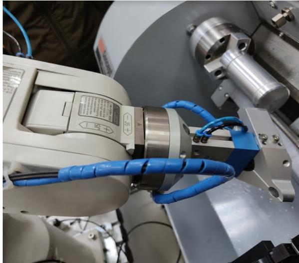
**Nota:** Extracción de la pieza mecanizada. (Chocho y Cuenca, 2022).
