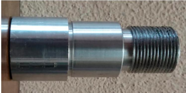
**Nota:** Se muestra el primer elemento mecanizado en el torno CNC. (Chocho y Cuenca, 2022).
