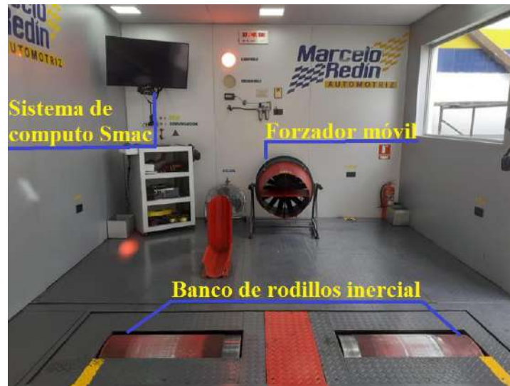
Figura 37.23: Banco de pruebas utilizado
