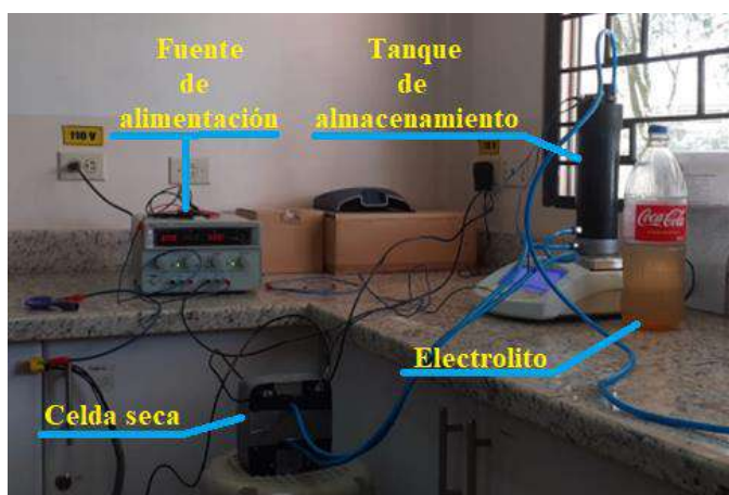
Figura 15.1: Montaje de sistema de oxihidrógeno
