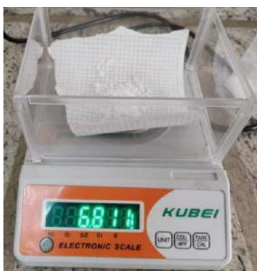
Figura 20.6: Peso de hidróxido de potasio
