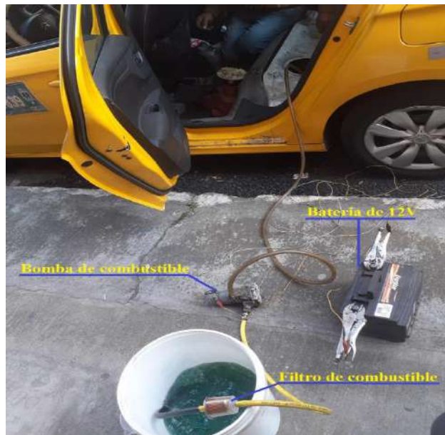
Figura 31.17: Montaje de extracción de gasolina
