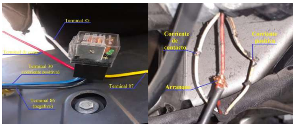
Figura 26.12: Terminales para conexión relé y switch de arranque
