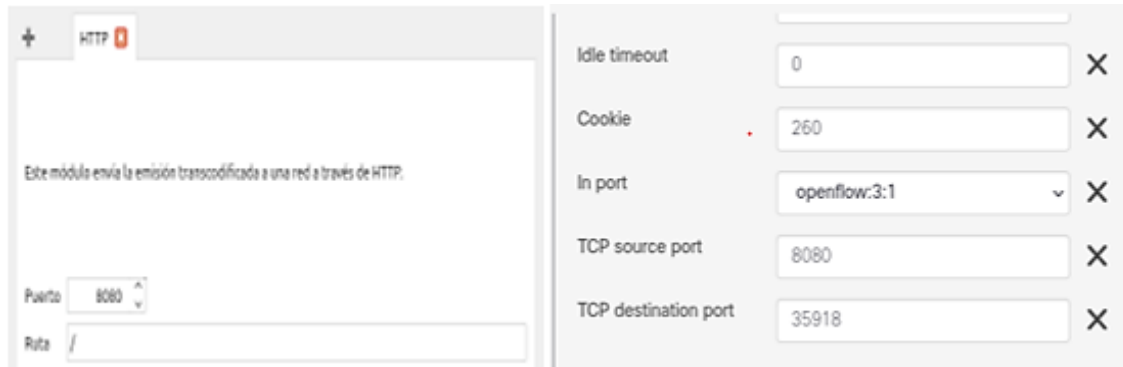
Figura 4.4 Instalación flujo con OpenFlow Manager
