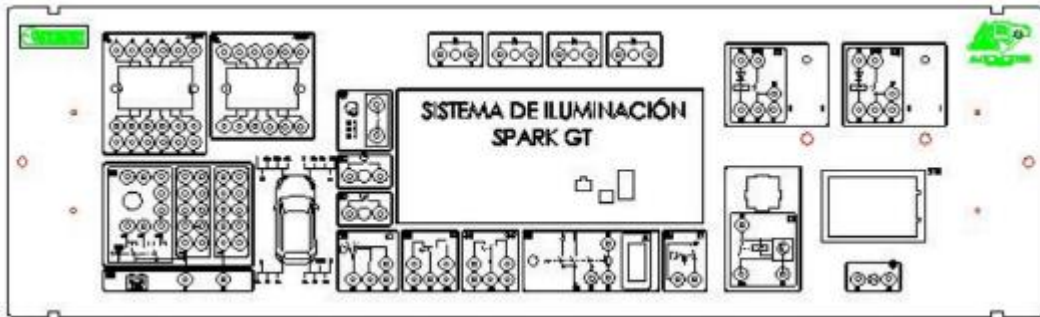
Figura 54. Diagrama de corte y grabado de panel de control
