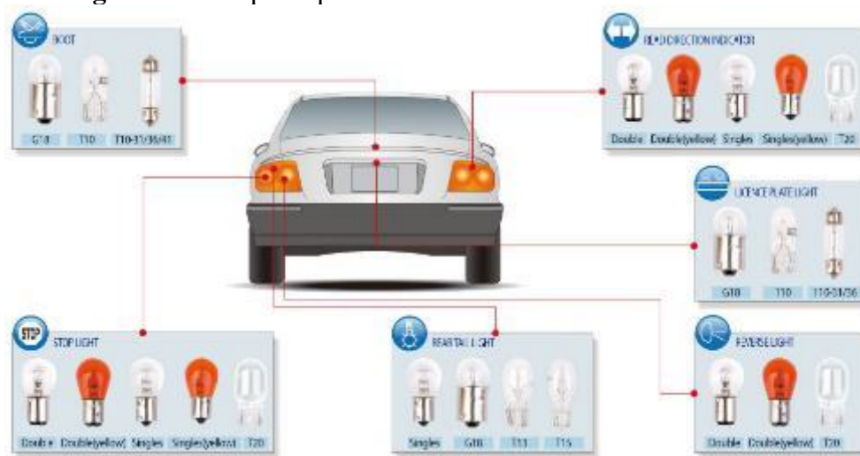
Figura 14. Lámparas pilotos del Sistema de Iluminación del Vehículo
