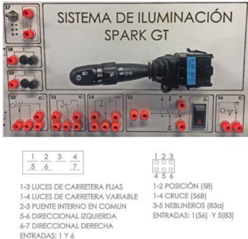
Figura 19. Diagrama de mando de control de intermitencia (S2, S3, S4, S5, S6)
