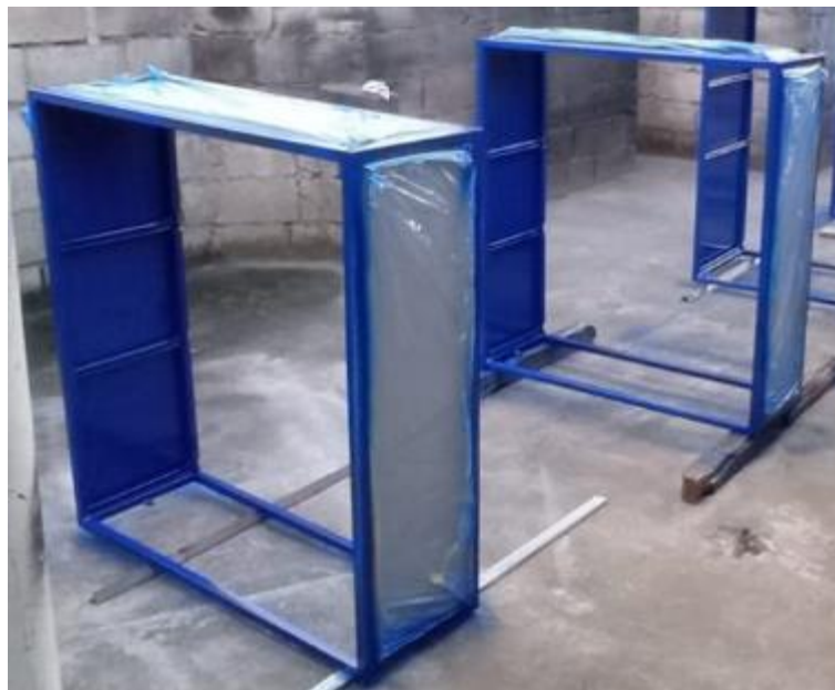
Figura 48. Pintura de estructura de paneles
