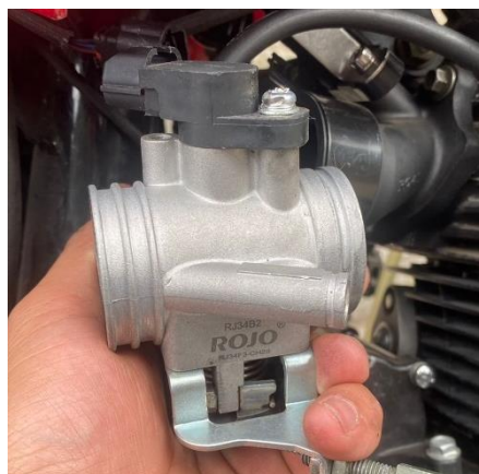
Figura 13. Cuerpo de aceleración.
