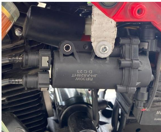
Figura 8. Bomba de combustible externa refrigerada por aire.
