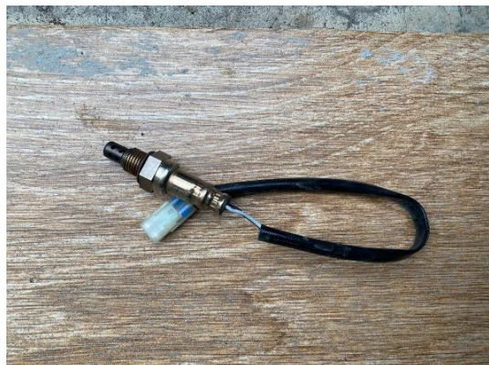
Figura 11. Sensor de oxígeno
