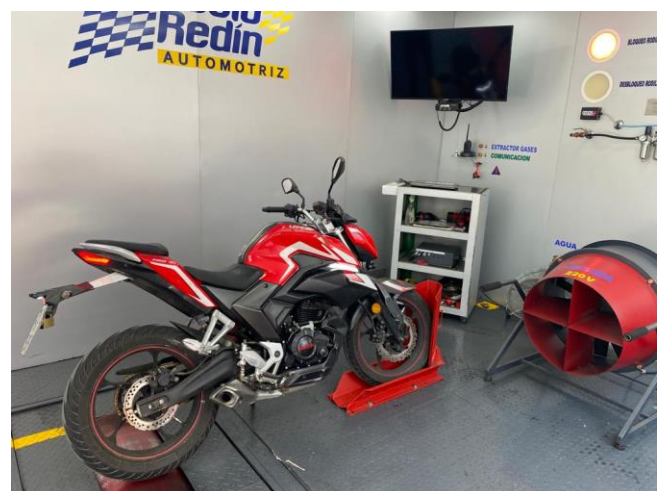
Figura 2. Motocicleta colocada en el banco de pruebas dinamométrico.
