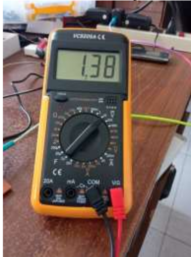
Figura 4.21 Lectura de voltaje del motor DC
