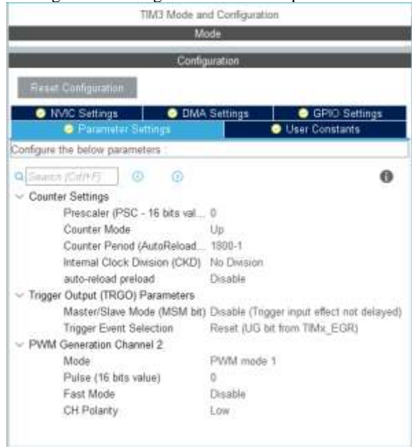
Figura 17 Configuración del timer para la PWM
