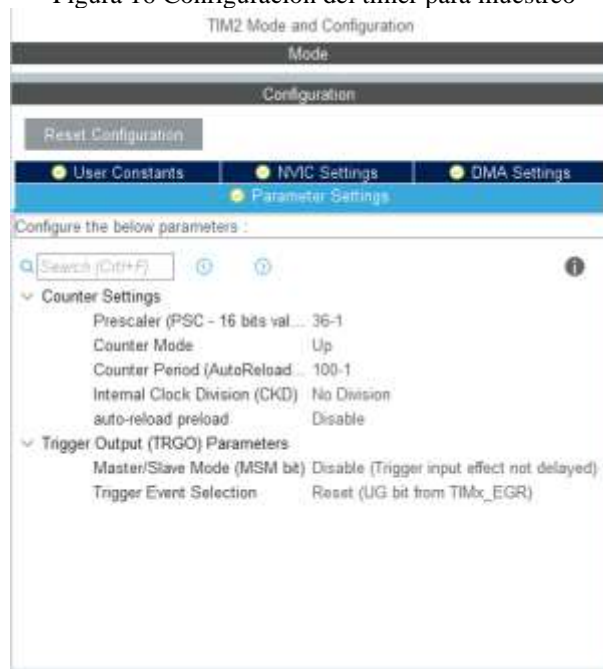
Figura 16 Configuración del timer para muestreo
