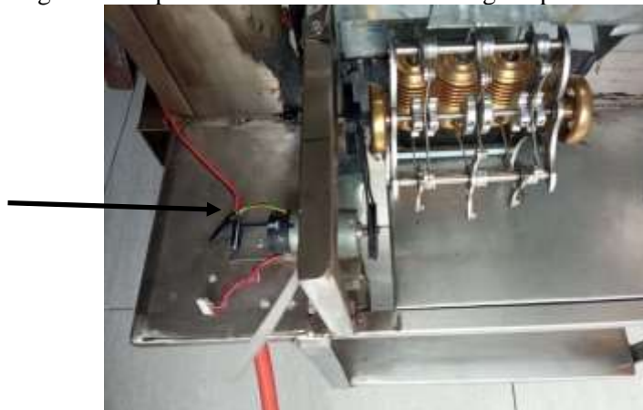
Figura 20 Implementación del motor Stirling acoplado al motor DC
