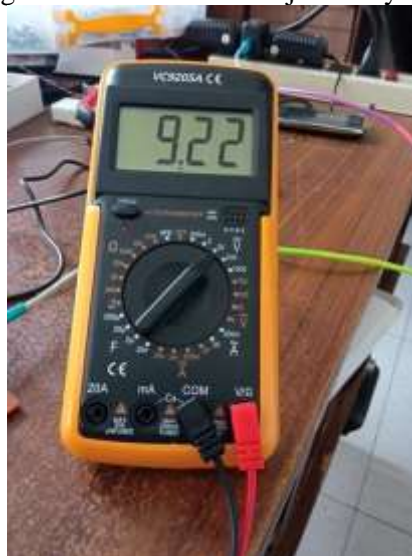
Figura 22 Lectura de voltaje del Flyback
