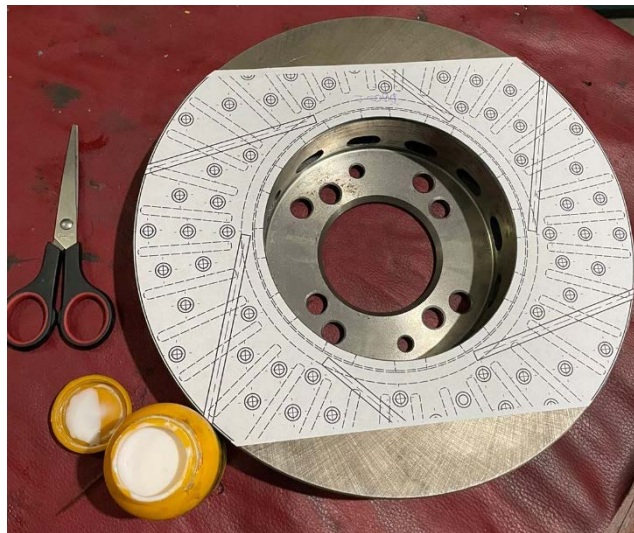
Figura 2.8 Plantilla pegada al disco de freno
