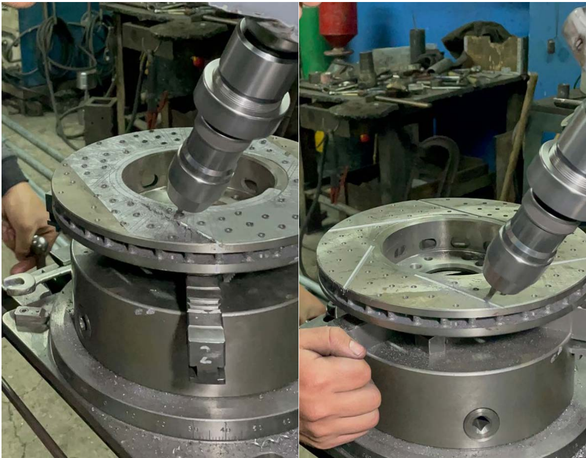
Avellanado de Discos Delanteros con Broca, Fuente: Autores
