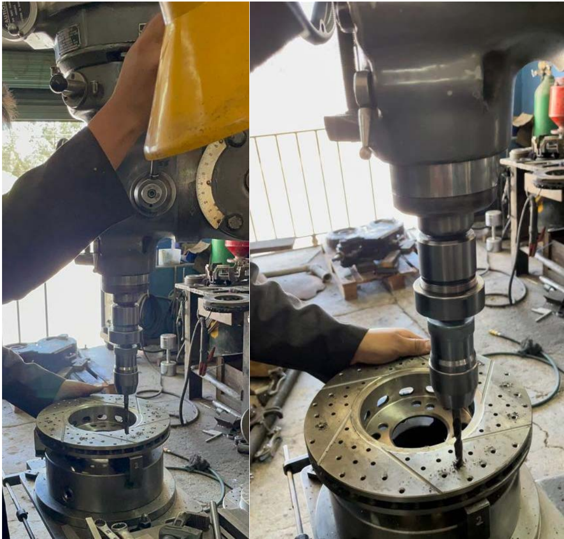
Avellanado de Discos Delanteros con Broca Fuente: Autores
