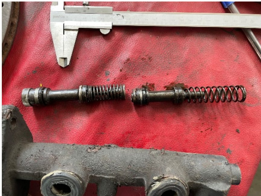
Bomba tándem Chevrolet Chevette despiezada, Fuente: Autores
